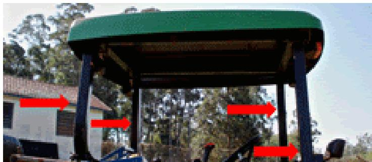
peso do trator e, em caso de tombamento, evitará que o operador seja esmagado dentro da plataforma de operação. Contudo a eficiência dessa estrutura de proteção só é possível com o uso de cinto de segurança.
